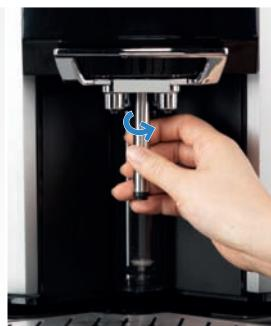
**Achtung:** Verbrennungsgefahr beim Abschrauben, die Temperatur der Düse kann hoch sein (>50°C).
